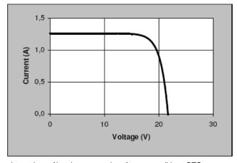
Les valeurs électriques sont données en conditions STC : 1kW/m², spectre solaire AM 1.2, termpérature 25°C.
