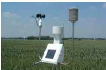
Station météo autonome en site isolé.
