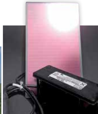
Ensemble d'alimentation pour réseau d'appel d'urgence (ou borne SOS).
